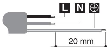
не менее 20 мм. Используйте исключительно кабель типа H05V2V2-F или аналогичный, рассчитанный на максимальную температуру 90°C. Замена должна производиться специалистом, который должен выполнять подключение к сети согласно приведенной ниже схеме.
