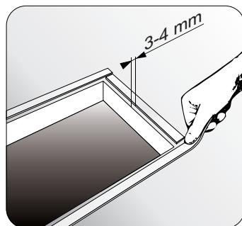
Выполнив эти операции, положите варочную панель на изолирующую прокладку и с помощью винтов и крепежных скоб прикрепите панель к опорной конструкции, обеспечив идеальную плоскость.
